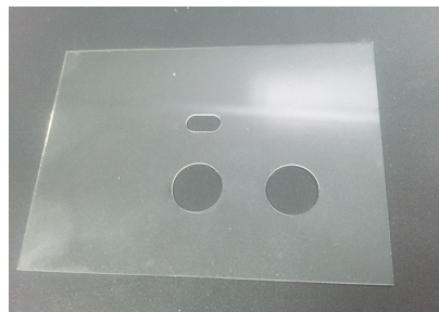
图 5. 切割样品宏观照，孔径 5mm
